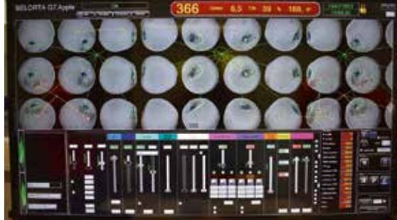
Äpfel werden in der neuen Anlage auf alle internen und externen Qualitätsparameter hin geprüft.
